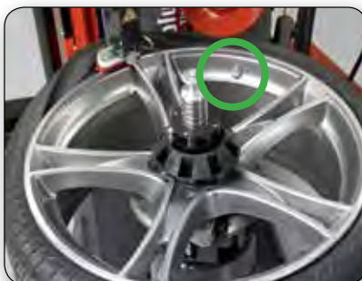
Демонтаж верхнего борта
