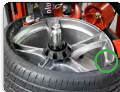
Монтаж верхнего борта
